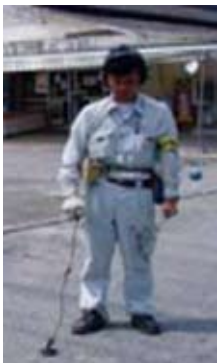
▲地面の中の水漏れの音がいないか調べる漏水調査官。
